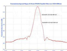
C波段上 1.8nm 滤光片的光谱形状
