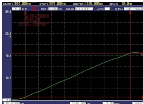
图 1: 1550nm 带宽 50nm 光谱图
