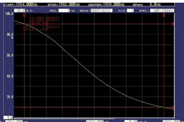
图 2: 1550nm 带宽 7nm 光谱图
