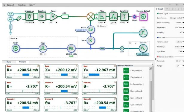
或者某个谐波信号分量。因此对于某些需要同时测量多个频率分量的幅值及相位的情况，传统锁相放大器是无法满足测量要求。双通道锁相放大器的数字端将 FPGA 与 ARM 技术相结合，实现更高的处理带宽及更灵活的数字架构，数字处理精度可达到 48 位，可同时进行 3 种频率的谐波测量（一个基带信号和它的两个 n 次谐波），使得 1 台双通道锁相放大器相当于 3 台传统锁相放大器。由于双通道锁相放大器具有两个独立的输入通道，因此可同时检测 6 种频率的谐波，最大谐波信号频率可达基频的 32,767 倍，但最大谐波频率不能超过仪器的最大工作频率 102 kHz。
