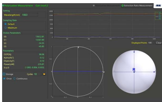
偏振测量软件界面（使用 1063 nm 激光器）显示偏振椭圆呈线偏振状态，椭圆度为 0.1°。
