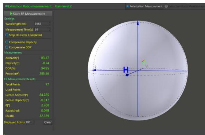
消光比测量软件界面（使用 1063 nm 激光器）显示消光比 ER = 32.339 dB，该界面也可用于保偏（PM）光等场景的偏振调整。
