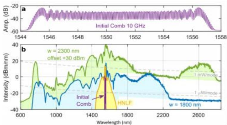
(上图) 基础电光频率梳的光谱, 可见 10 GHz 的梳齿。
