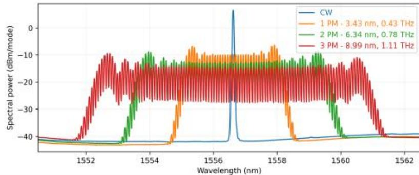
基础电光频率梳在启用不同数量相位调制器时的输出光谱。当三个相位调制器 全部启用时，光谱在 -10 dB 水平处可达到约 9.0 nm (约 1.1 THz) 的带宽。在使用 1、2 或 3 个相位调制器 的情况下，强度调制器也同时处于工作状态。
