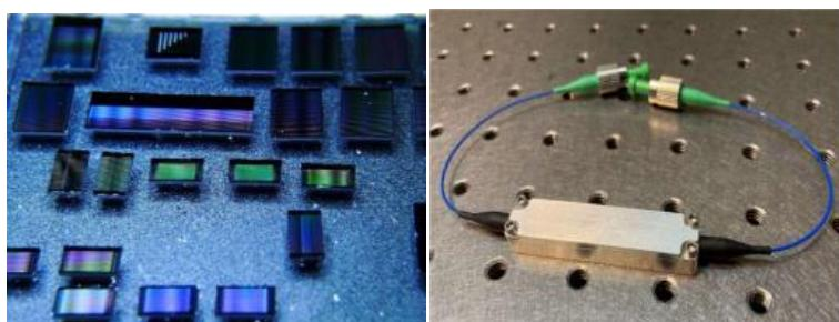
(左) 用于超连续生成的纳米光子芯片; (右) 带光纤输入/输出的封装 DESMO 模块。
