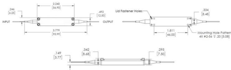
尺寸以英寸为单位 [括号内为毫米], 配备底板, 可直接安装于标准光学台。
