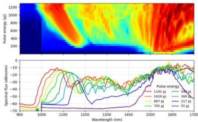
从中心波长 1560 nm、重复频率 100 MHz、脉冲宽度 80 fs 的激光，在 0.5 m 长的 PMHN5 HiFi 中产生超连续谱。
