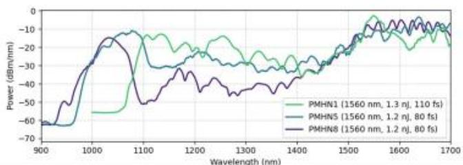
从中心波长 1560 nm 的 100 MHz 飞秒激光产生 950–1450 nm 的光谱。每段非线性光纤长度为 0.5 m。在输入脉冲能量约 1 nJ 时, 可产生宽带光, 光谱峰值可根据光纤类型在
