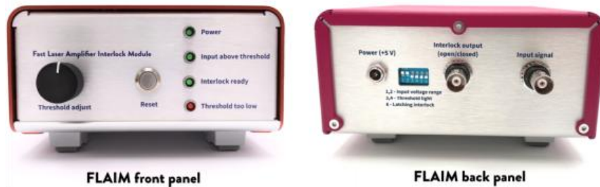
图 1. 筱晓光子快速激光放大器联锁模块（FLAIM）的前后面板。前面板包含用于控制联锁行为的旋钮和按钮，以及 4 个指示设备运行状态的指示灯。后面板设有一个电源连接器和 BNC 连接器。
